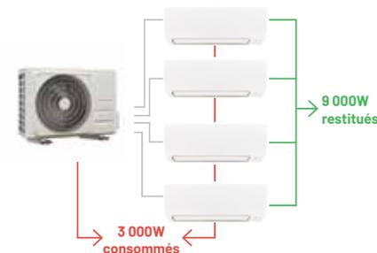
\* Le taux d'efficacité énergétique (EER), qui détermine la classe énergétique, compare la puissance consommée à la puissance restituée en chaud ou en froid. Plus la différence est grande, plus l'équipement est efficace. Dans cet exemple l'EER est de 3 -> il consomme 3 000W pour les transformer en 9 000W de froid (attention de comparer les mêmes unités de mesures -> voir outil de conversion dans «Air Conditioning Calculation FR-ENG»).
