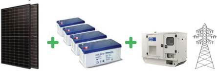
Panneaux solaires Batteries lithium ou plomb gel Générateur et/ou réseau de ville en back up
