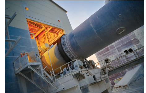
Four rotatif de cimenterie à +/- 1450°C
