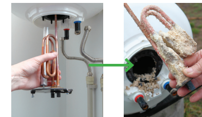
THERMOPLONGÉE résistance en contact direct avec l'eau (généralement moins cher)
